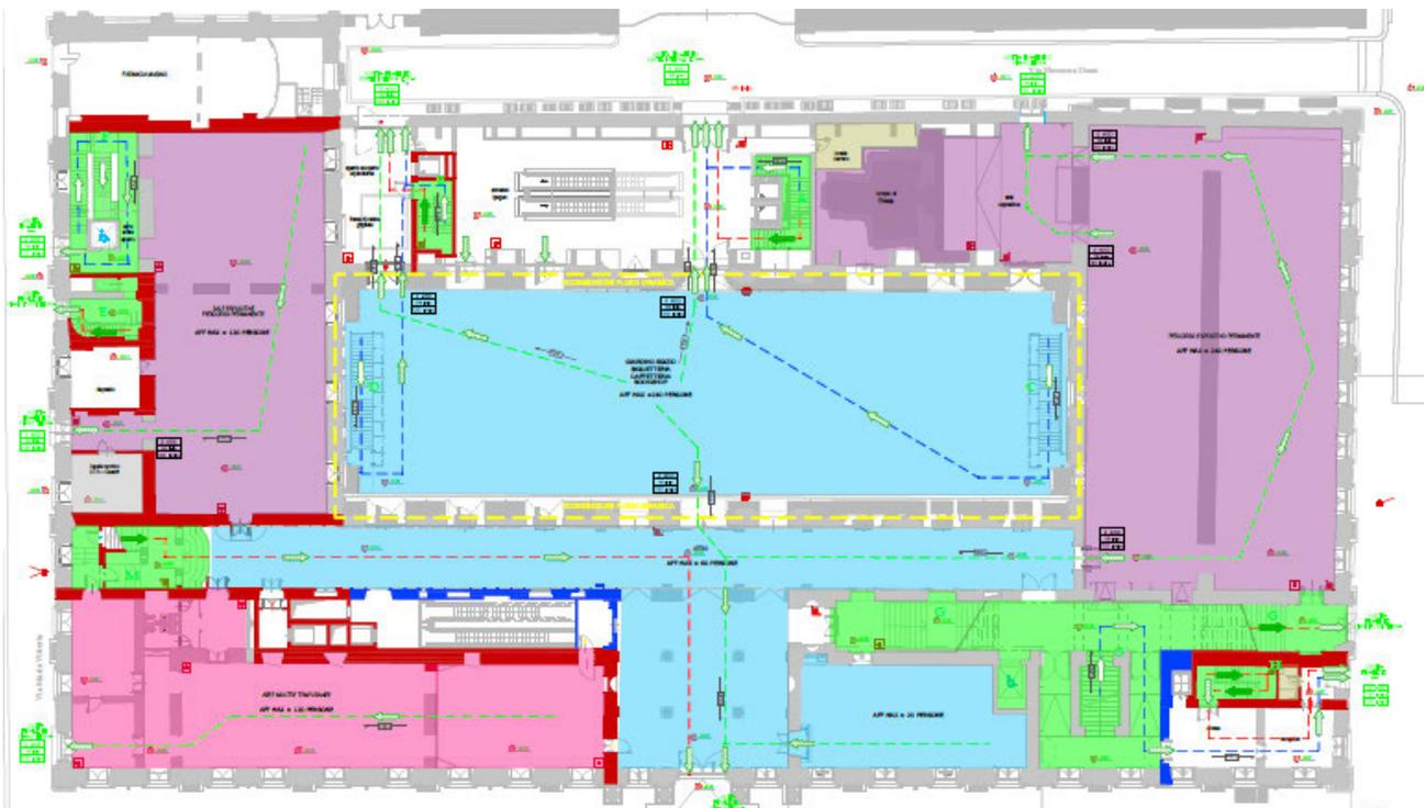
Figura 7 – Individuazione dei nuovi percorsi d'esodo al piano terra
